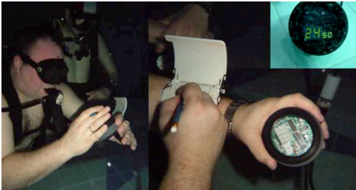
Figure 19. Dispositif de mesure sous-marin du CFFF construit par HBT.
