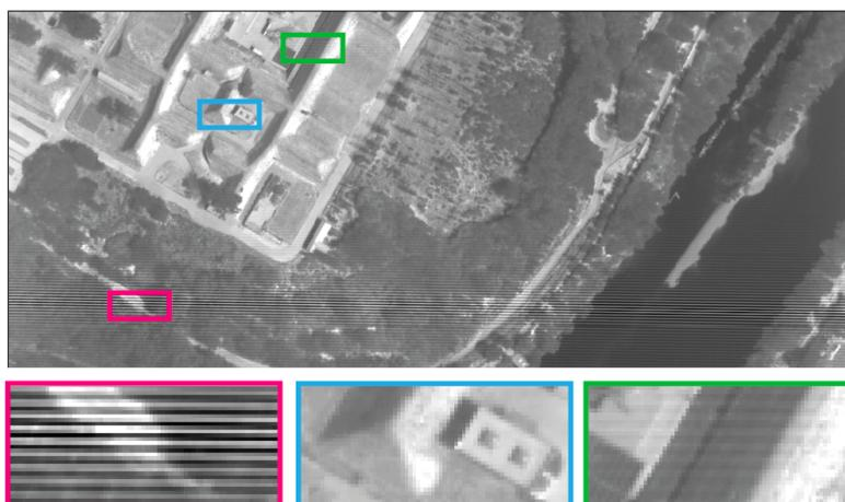
FIGURE 1.7 – **Image issue de Sieteletters.** - Les franges du carré rose, autour de  $\delta = 0$  sont très contrastées. Elles sont brouillées sur le carré bleu en raison de la grande ouverture spectrale de l'instrument. Puis, vers le haut de l'image, dans le carré vert, les franges sont à nouveau contrastées mais plus légèrement.
