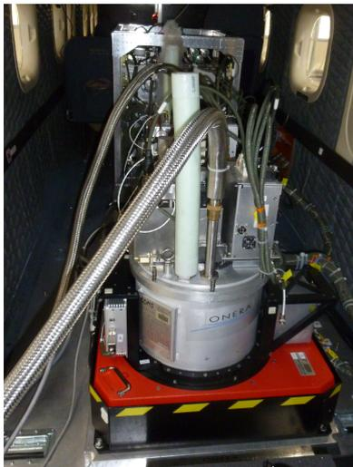
FIGURE 1.4 – Sieletters BIII monté sur plateforme stabilisée.
