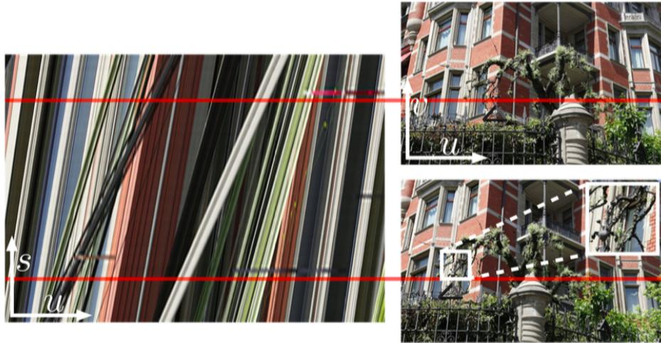
FIGURE 2.8 – **Construction d'une image des plans épipolaires.** - A droite, deux images issues d'une séquence acquise par un déplacement rectiligne vers la droite. Les lignes épipolaires correspondantes sont surlignées en rouge, et la ligne est prolongée pour montrer leur position sur l'image des plans épipolaires à gauche.  $s$  est l'axe des numéros d'images,  $u$  est l'axe spatial de la direction du mouvement et  $v$  est l'axe spatial transversal au mouvement. Source : [KZP13]
