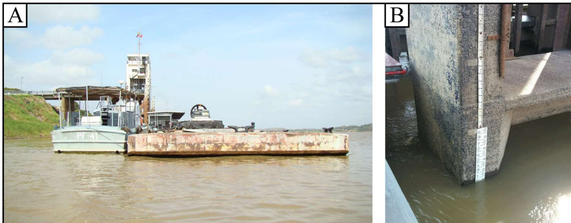
Figure 19. (A) Port flottant du "Comando fluvial de Ciudad Bolívar". (B) Règle limnimétrique dans la station hydrologique de Ciudad Bolívar, à l'intérieur des installations de cette station militaire.
