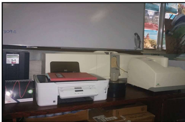
Figure 21 . Mesures granulométriques à l'aide d'un analyseur granulométrique de la taille des particules de marque Malvern, modèle Mastersizer 2000G.
