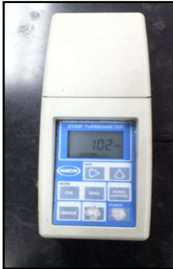
Figure 22. Mesure de la turbidité à l'aide d'un turbidimètre portable 2100P de marque Hach avec une plage de sensibilité de 0-800 NTU (Unités de Turbidité Néphélométrique).
