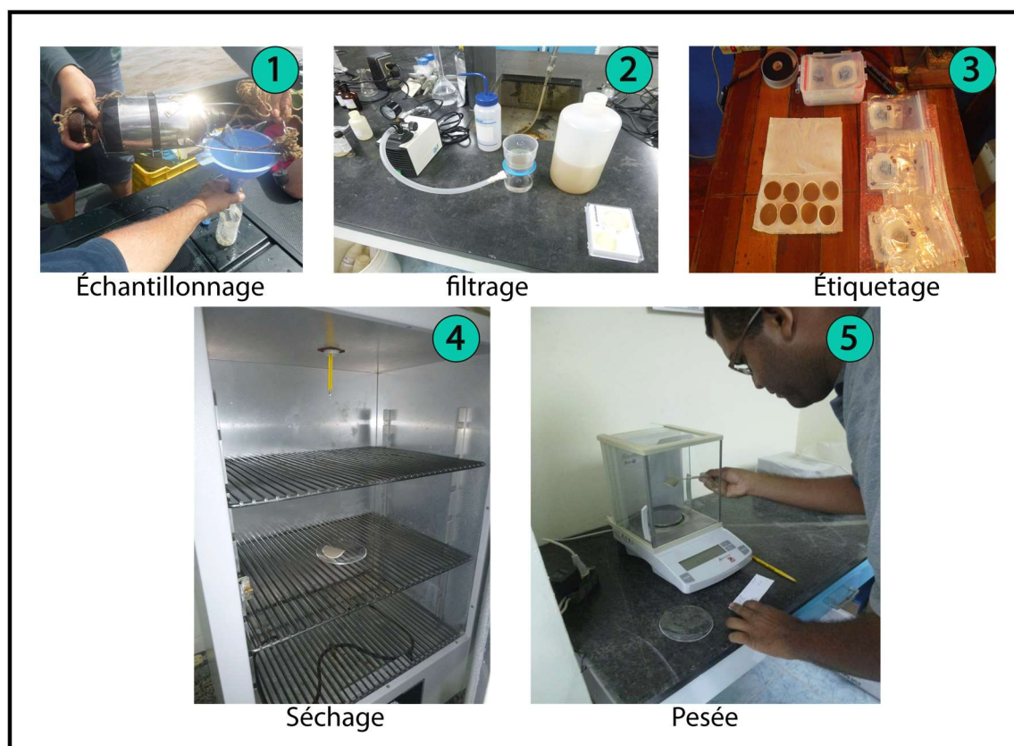
Figure 20. Protocole établi par l'Observatoire SNO-Hybam pour le calcul de la concentration des sédiments en suspension. Procédures depuis l'échantillonnage dans le fleuve jusqu'au calcul de la valeur de concentration de MES.
