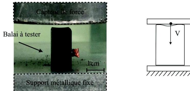
FIGURE 5.3 – Début d'un essai de compression.
