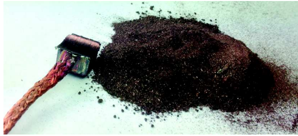
FIGURE 5.11 – La nuance de balai avec 95% de cuivre est usée au bout de quelques minutes d’essai. Les poudres sont les débris collectés.
