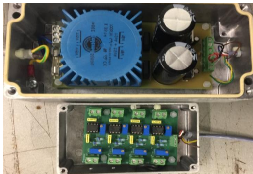
Figure III. 35 Conditionneur Pt 1000 à 4 voies et son alimentation
