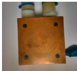
Figure II. 33 Photographie d'un diffuseur thermique MOT classique (à échangeur métallique)
