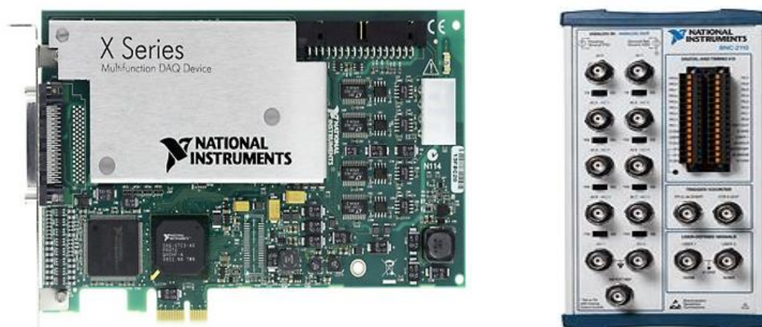
Figure III. 20 Carte d'acquisition NI PCIe 6361 et son bloc de connexions
