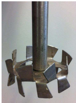
Figure 2-4 : Pâle défloculante utilisée pour malaxer les coulis cimentaires.
