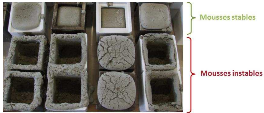
Figure 1-39 : Effondrement de mousses de ciment. Source : LafargeHolcim.
