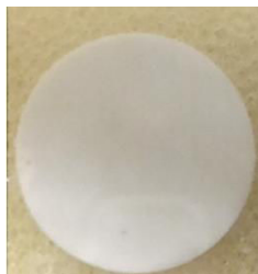
Figure II-12: Photographie d'une pastille (Sr_2Ta_2O_7)_{100-x}(La_2Ti_2O_7)_x après frittage de diamètre 11,5 mm et d'épaisseur 0,5 mm (on remarque l'aspect incurvé de l'échantillon)
