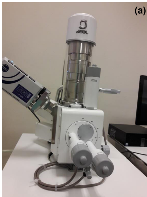
(a) MEB JEOL JSM-IT200 équipé d'un détecteur de rayons X « EDS » Oxford Inca Energy du département SGM de l'IUT de Saint Briec, (b) schéma de principe de la colonne électronique.
