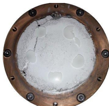
Figure III-39 : Cible (Sr_2Ta_2O_7)_{98,35}(La_2Ti_2O_7)_{1,65} enrichie à l'aide de 5 pastilles de Sr_{1,4}Ta_{0,6}O_{15}
