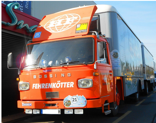
FIGURE 1.2 – Exemple d’optimisation empirique : le déflecteur d’air installé au-dessus de la cabine permet de dévier l’écoulement, ce qui permet de diminuer la traînée associée. (photo placée dans le domaine public)
