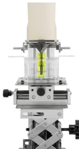
Figure 29 : Photo des plaques vibrantes du viscosimètre utilisé pour la mesure de la viscosité de la salive.
