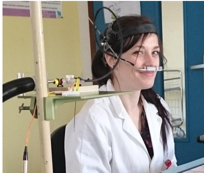
Figure 62 : Casque support avec embout nasal et système de chauffage pour prélèvement des effluves nasals en vue d'une analyse du « nosespace » d'un sujet.
