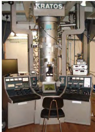
Figure II-3. Microscope électronique en transmission très haute tension (MET-THT) du SRMA au CEA de Saclay.
