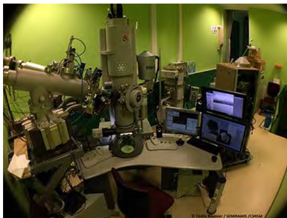
Figure V-4. Couplage de l'implantateur d'ions IRMA avec un MET FEI Tecnai G 2 20 Twin au CSNSM d'Orsay.
