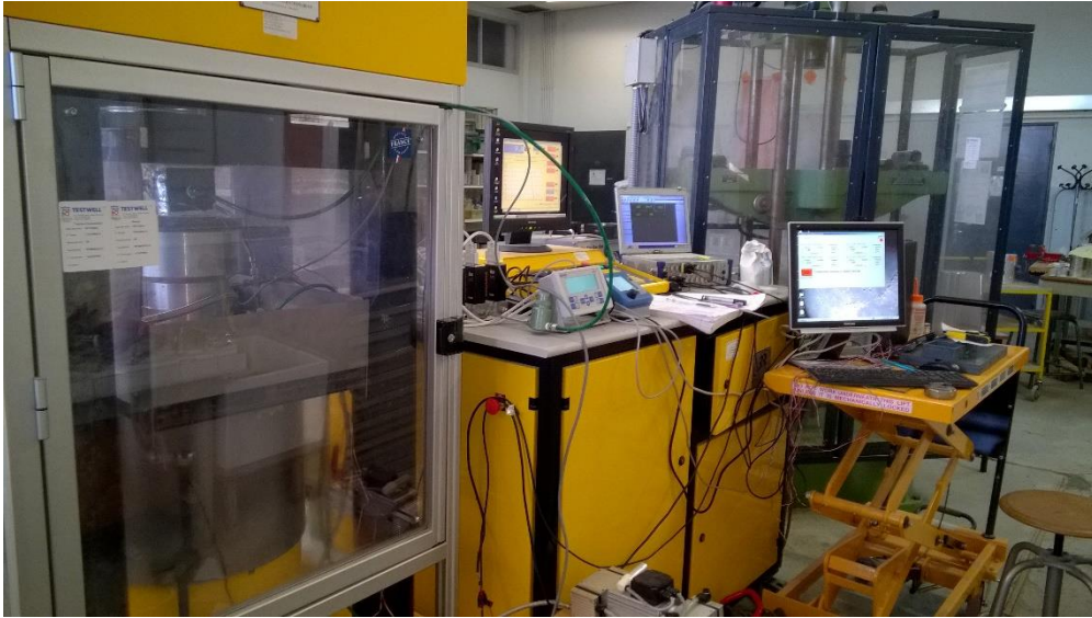
Figure A.13. Mesure de la perméabilité avec la technique de la double cloche sous charge de compression mécanique
