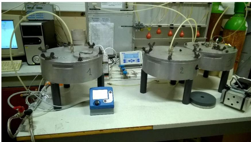
**Figure A.11.** Adaptation du dispositif Cembureau pour mesure de la perméabilité en dépression avec la technique de la double cloche et à la cloche simple
