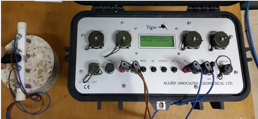
Figure A.14. Matériel de mesure de résistivité (quadripôle de Wenner + résistivimètre)
