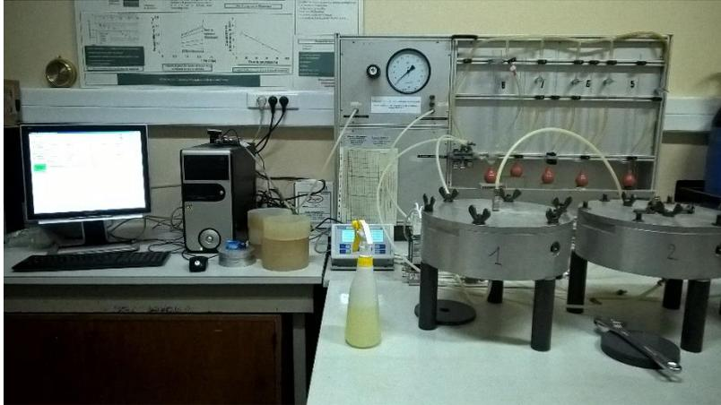
**Figure A.10.** Mesure de la perméabilité avec le perméamètre Cembureau
