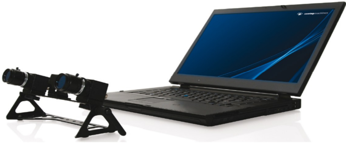
Figure 116 : Emetteur infrarouge et caméras de l'eyes tracker « Face LAB 5 » du Laboratoire LOUSTIC Brest devant un ordinateur de test.
