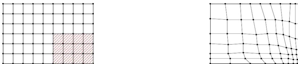
Figure 5: Maillage de base avec la zone d'intérêt à raffiner en hachurée et maillage raffiné avec la méthode  $r$
