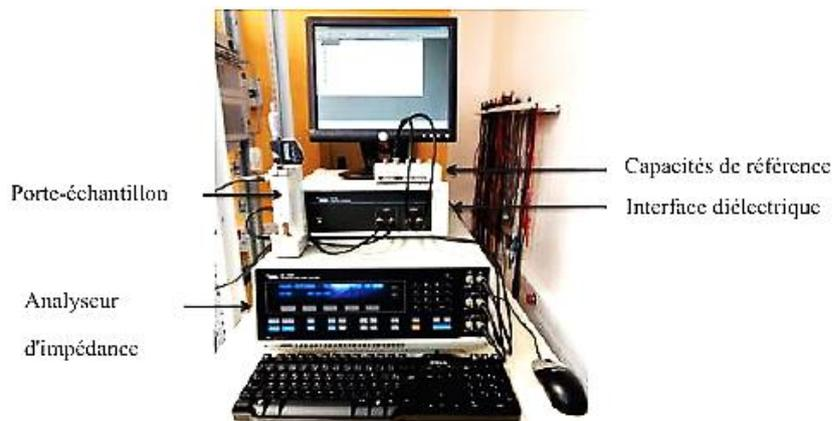
Figure 3.14 : Banc de spectroscopie diélectrique utilisé pour l'étude
