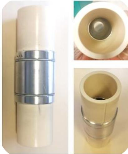
Figure 3.8 : Echantillon après démoulage et usinage
