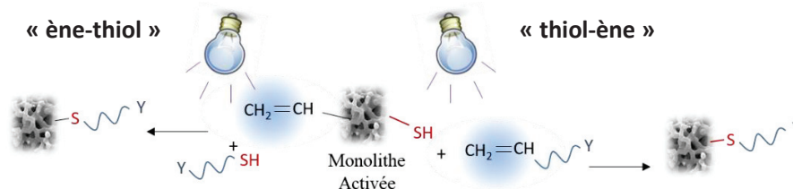
Figure 14. Deux approches possibles pour le greffage d'un groupement fonctionnel par photo-click thiol-ène.
