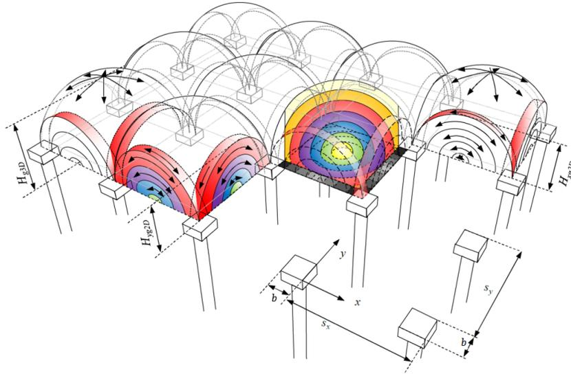
Fig. 1.7. Concentric Arches model (van Eekelen et al., 2013)
