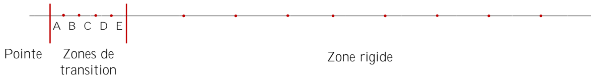
FIGURE 3.53 – Modélisation du guide dont les propriétés mécaniques élastiques varient suivant différentes zones de transition (d’après les résultats expérimentaux du Chapitre 2).
