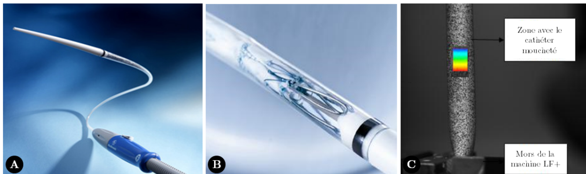
FIGURE 2.25 – (A-B) Cathéter avec une endoprothèse non déployée à l'intérieur (images issues de Medtronic © ) (C) Tests de traction sur la partie contenant l'endoprothèse mouchetée en blanc sur fond noir (Mouktadiri, 2013).
