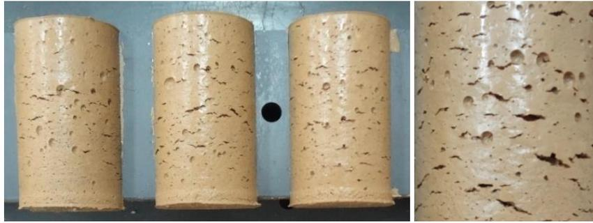
Figure 79 : Aspect de surface d'éprouvettes de mortier gélifiées au démoulage (24h après coulage, sans séchage)
