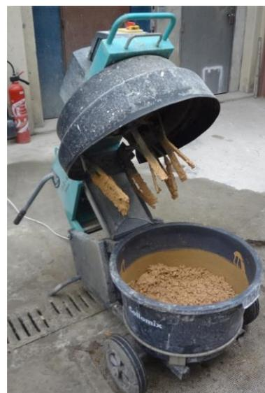
Figure 128 : Malaxeur à béton Collomix utilisé pour la réalisation des gâchées
