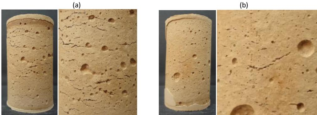
Figure 80 : Aspect de surface d'éprouvettes de mortier gélifiées après séchage. (a) Exemple d'un cas extrême (composition "E7" : [LV / 12 g/l / 200 / 1,75],  $R_{24h} = 0,028$  MPa) et (b) d'un cas peu marqué (composition "E2" : [HV / 6 g/l / 175 / 1,75],  $R_{24h} = 0,047$  MPa)
