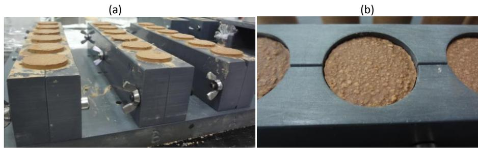
Figure 77 : (a) Mise en évidence de l'expansion volumique du matériau survenant lors de la gélification. Ce cliché est pris 24h après coulage d'une des compositions du plan d'expériences, juste avant démoulage et sans séchage. (b) Mise en évidence du retrait au séchage. Cliché pris 6 jours après séchage dans les moules par une seule face
