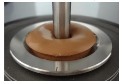
Figure 95 : Illustration de l'expansion volumique observée en fin de suivi
