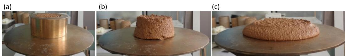
Figure 40 : Test de la table à choc. (a) Mortier coulé dans le moule, (b) moule retiré, (c) l'étalement peut-être mesuré après 15 coups
