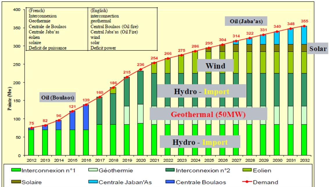
Figure 1.8 - Plan d'approvisionnement en électricité (Source EdD)
