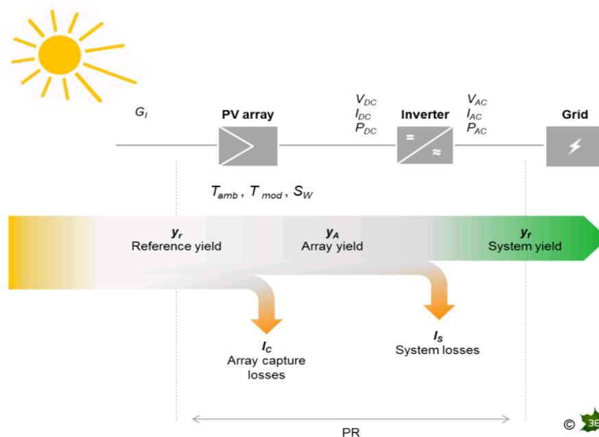
Figure 3.3 - Chaîne de conversion de l'énergie
