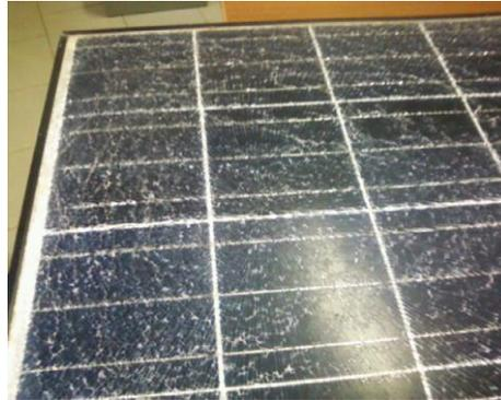
Figure 4.5 - Module PV avec verre fissuré [82]
