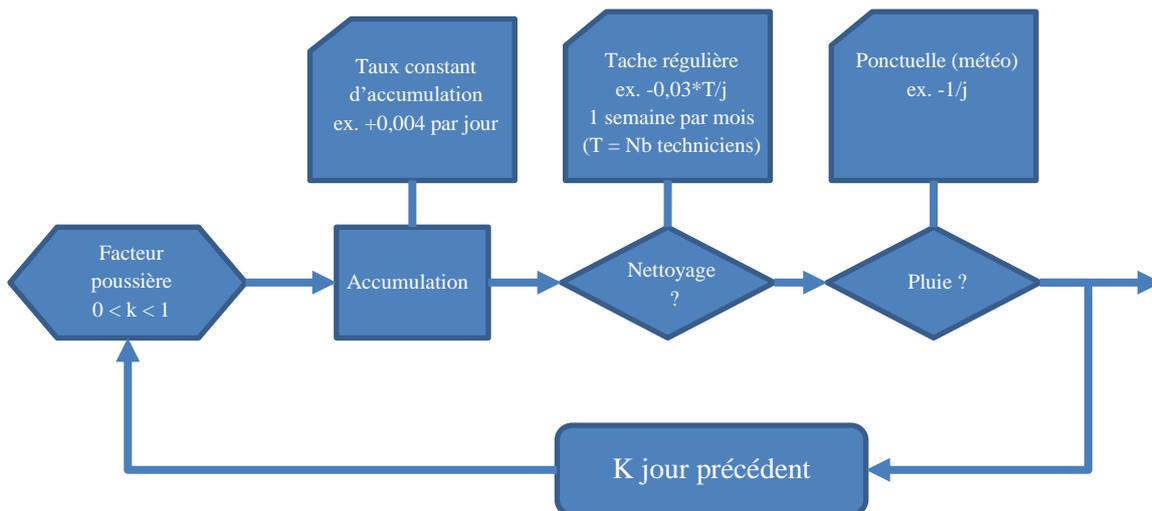
Figure 5.12 - Modèle phénoménologique de simulation de poussière
