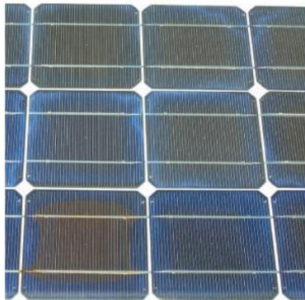
Figure 4.2 - Module présentant une décoloration [72]
