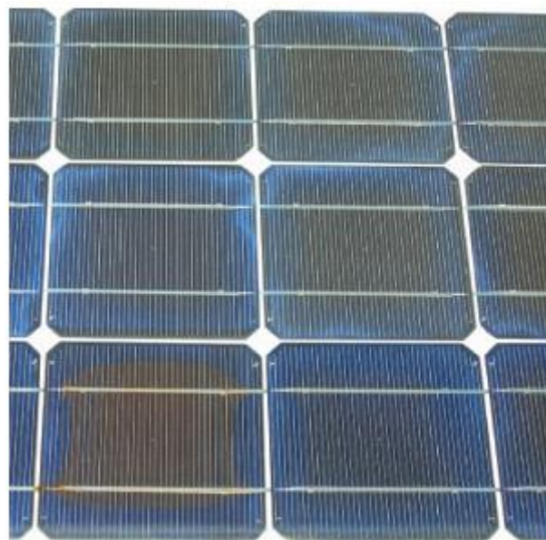
Figure 4.2 - Module présentant une décoloration [72]
