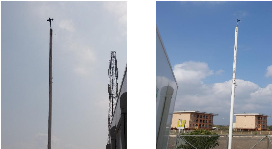
Figure 2.27 - Anémomètre et girouette
