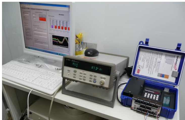
Figure 2.30 - Systèmes d'acquisitions de vitesse et direction du vent et températures des modules
