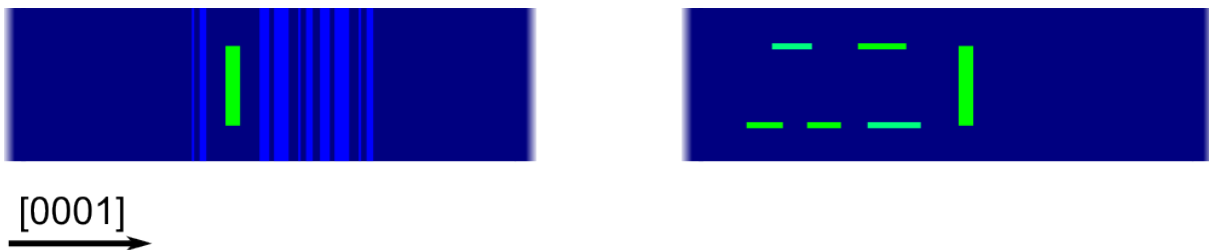
FIGURE 4.20 – Représentation schématique des structures parasites possibles, avec à gauche la présence d'inclusions ZB en bleu clair, et à droite la présence de PQs radiaux partiels d'InAs en vert.
