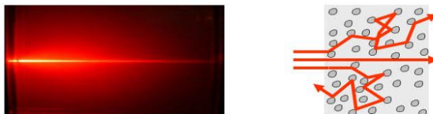
Figure 11. Propagation de la lumière à travers un milieu diffusant
