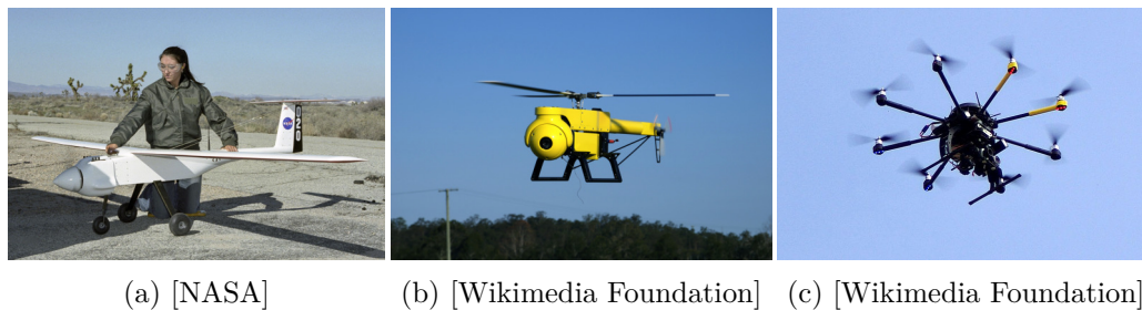
FIGURE B.1 – Divers plateformes MAV : de gauche à droite un aéronef à voilure fixe, un hélicoptère et un multi-rotor.
