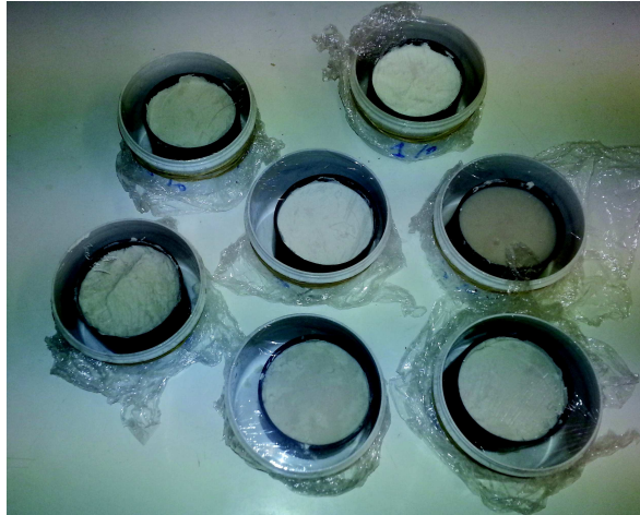
FIGURE 2.16: Photo des échantillons de billes de verre \Phi < 50 \mu m avec différentes teneurs en eau.
