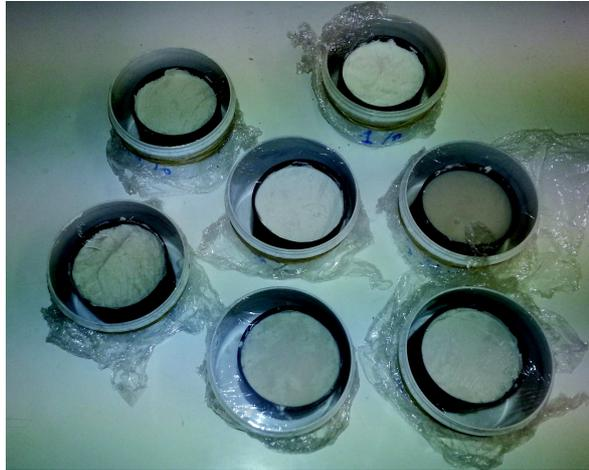
FIGURE 2.16: Photo des échantillons de billes de verre  $\Phi < 50 \mu m$  avec différentes teneurs en eau.
