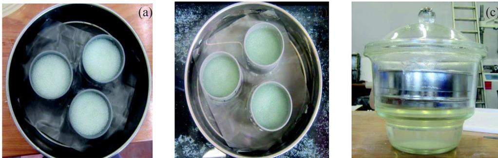
**FIGURE 2.2:** (a) Mise en place, (b) saturation et (c) drainage des échantillons au cours de la détermination de la teneur en eau de rétention  $w_{(R)}$
