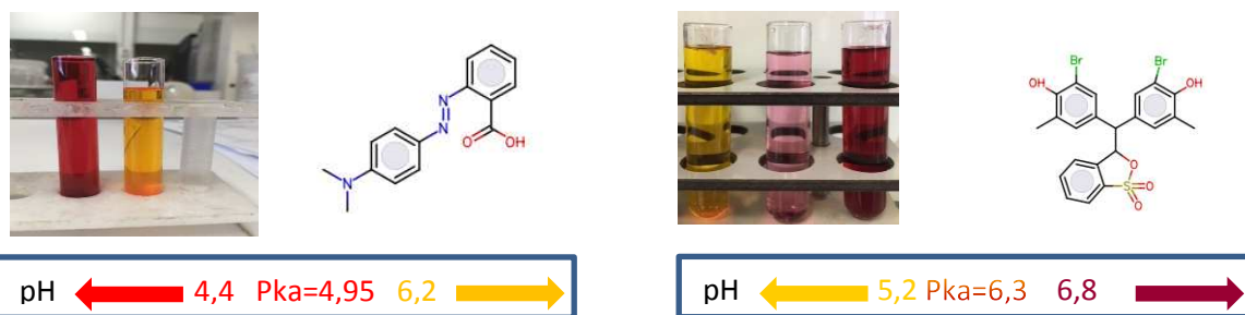
Figure-III. 13 : indicateurs colorés. À gauche le rouge de méthyle, à droite le Pourpre de bromocrésol. Structure. Pka et couleur en fonction du pH
