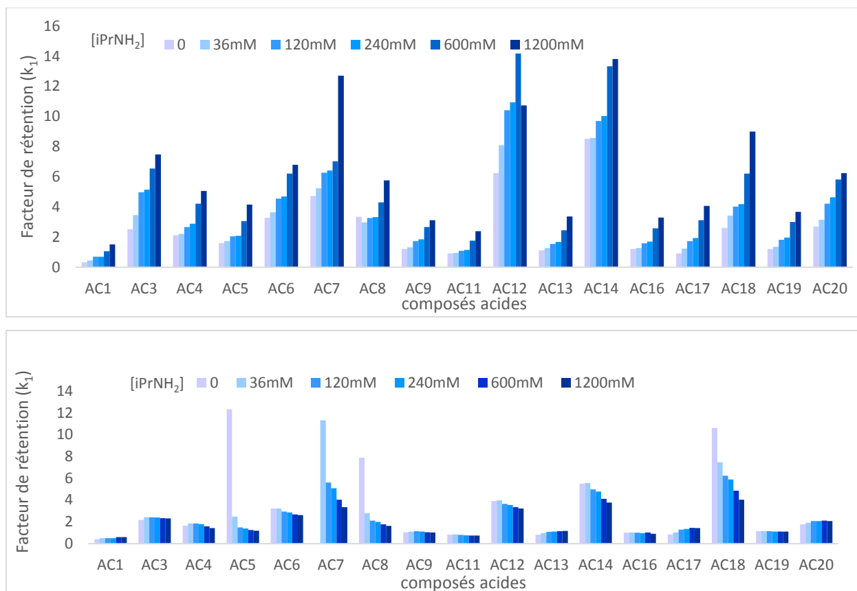
Figure-II. 41: évolution des facteurs de rétentions du premier énantiomère élu en fonction de la concentration en isopropylamine lors de l'analyse de composés chiraux ayant un caractère acide. Au-dessus Chiralpak AD-3 en dessous : Chiralcel OD-3 100x4,6 mm. Phase mobile : CO 2 /EtOH(+X mM iPrNH 2 ) 90/10 X : varie de 36 mM (0.3% v/v) à 1 200 mM (10% v/v), Débit : 3,5 mL/Min Température : 35°C. Pression de sortie : 10,5 MPa
