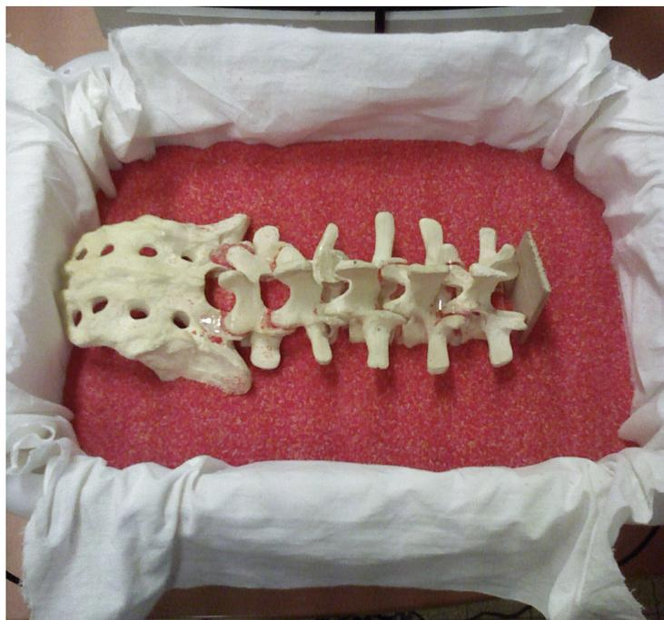
**Figure 36. Boîte de simulation constituée d'une colonne en résine et d'une vertèbre à double densité L3 disposée au milieu de micro billes.**
