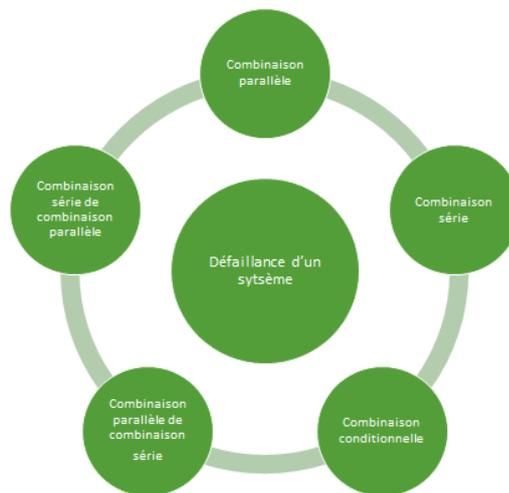
FIGURE I.18 – Combinaison des modes de défaillance
