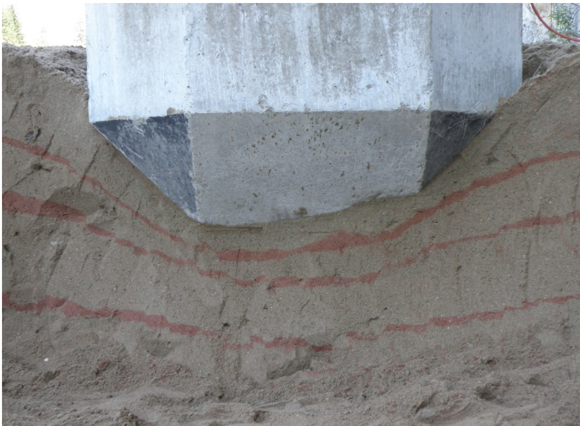
Figure 6.11 : Photo après excavation du remblai de l'essai D2B4H3C2
