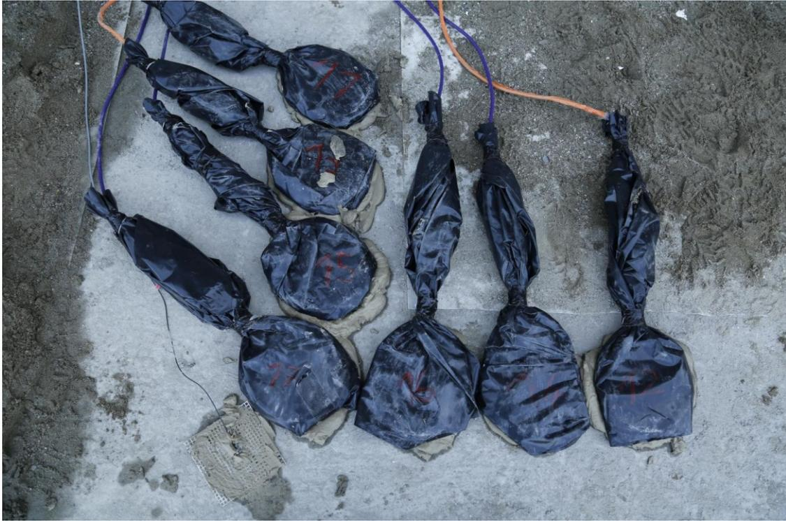
Figure 3.6 : Mise en place des capteurs de pression et d'un des accéléromètres, scellés à la dalle.
