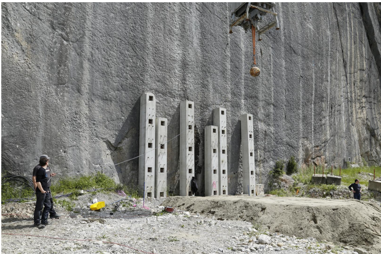
Figure 3.21. Réalisation de l'essai numéro 1 – Photo au démarrage de l'essai (épaisseur de sable 1 m, diamètre d'impacteur 0.42 m, hauteur de chute 5 m)
