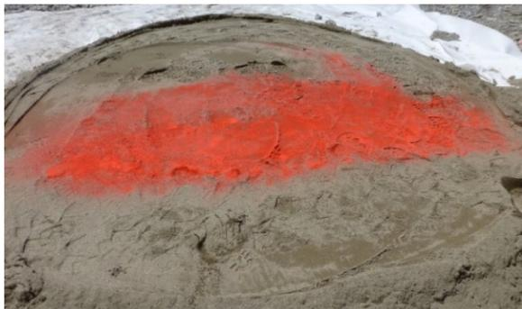
Figure 3.8 : Dispositifs de mise en évidence des déplacements dans la couche de sable protectrice
