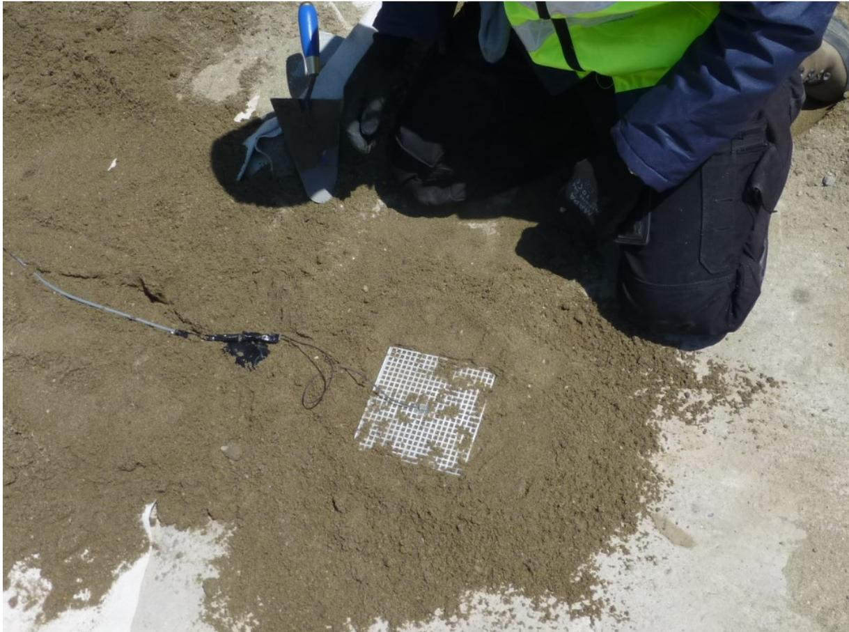
Figure 3.4 : Positionnement d'un accéléromètre au sein de la couche amortissante
