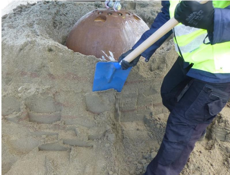
Figure 3.19 : Excavation manuelle du sable dans un plan vertical – Essais préliminaires, remblai B
