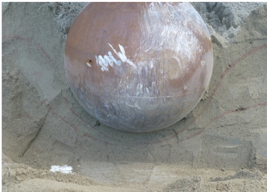
Figure 3.9 : Dispositif retenu pour mettre en évidence les déplacements dans la couche de sable : couches intermédiaire de sable coloré
