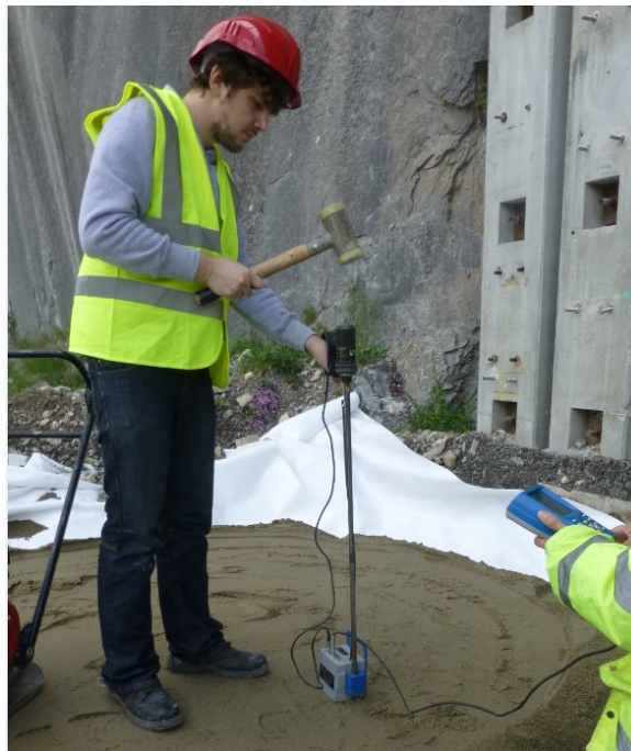
Figure 3.14 : Contrôle de l'homogénéité du compactage au pénétromètre PANDA
