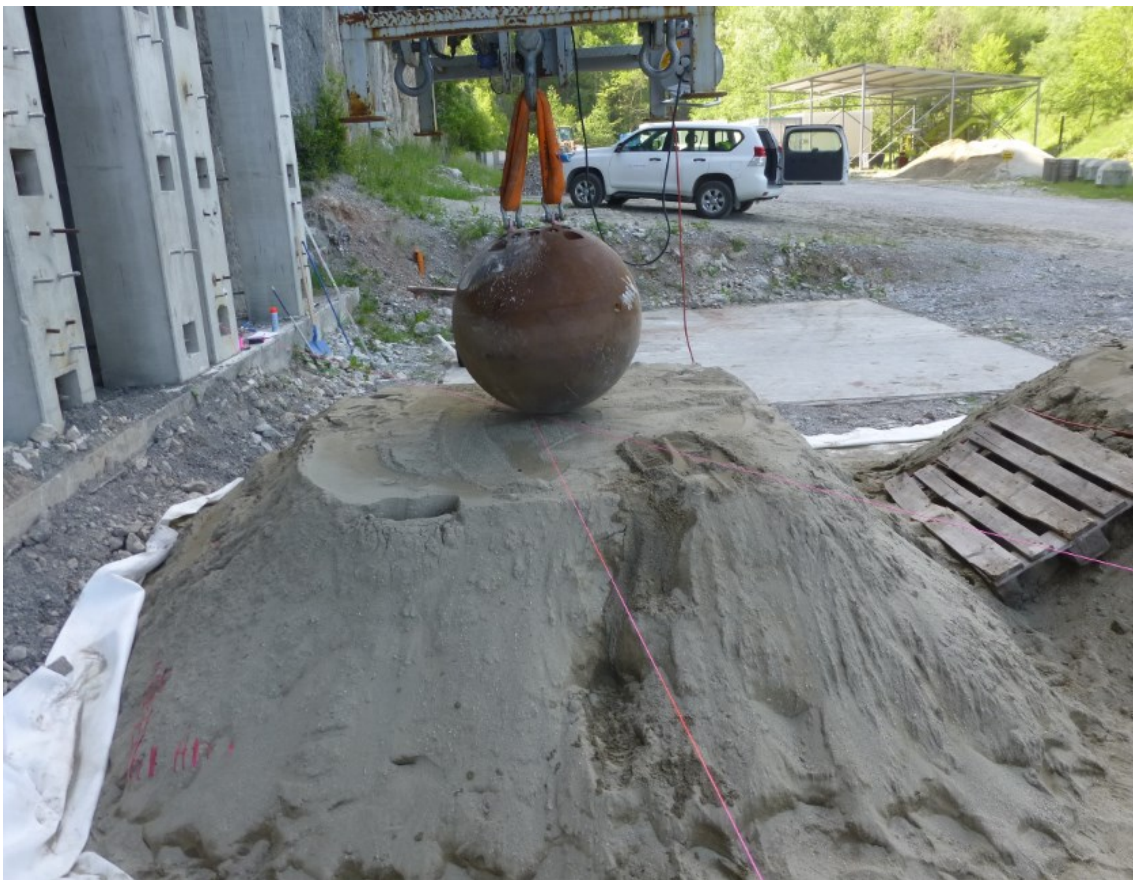
Figure 3.16 : Positionnement de l'impacteur au droit du point d'impact visé
