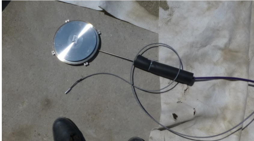
Figure 3.5 : Capteur de pression utilisé pour observer les pressions agissant sur la dalle
