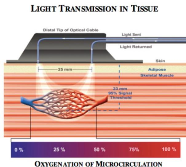
**Figure 23. Schéma du principe de mesure de NIRS.**
