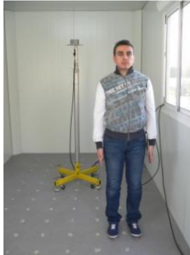
Fig. IV.12 - Mesure de la puissance reçue à 1,8 m en présence d'un corps humain
