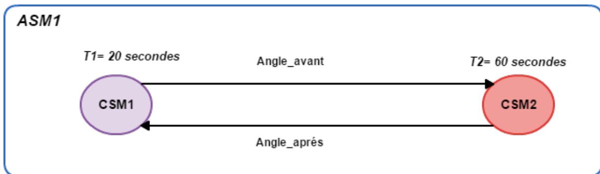
FIGURE 6.11 – Automate de composition de l'architecture ASM1.
