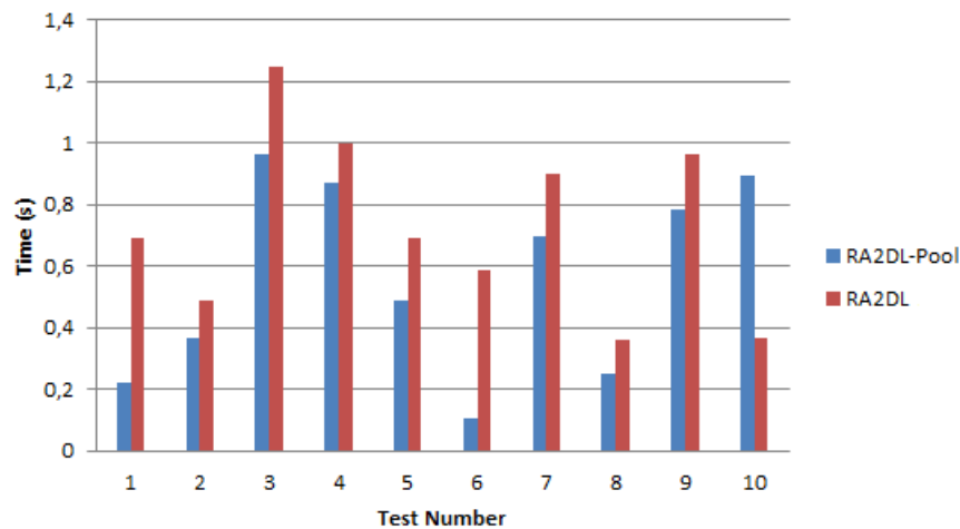
FIGURE 6.28 – Évaluation du temps de RA2DL sans et avec Pool du système BMS.
