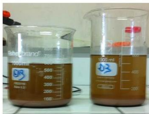
c) Dilution de la pulpe de reprise à l'eau à un ratio L/C de 4 par 3
