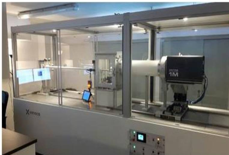
Figure III- 9: Plateforme de diffusion des rayons X aux petits angles (SAXS, XEUSS 2.0) installée au Laboratoire de Génie Chimique à Toulouse.
