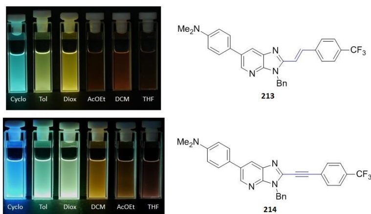
Figure 72. Photographies de cuves contenant les composés 213 et 214 en solution dans les six solvants de l'étude, à concentration constante, sous irradiation UV.
