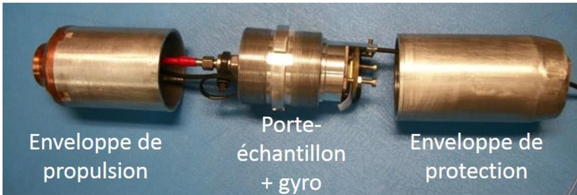
Figure 4.31 : Véhicule cargo avec gyro embarqué
