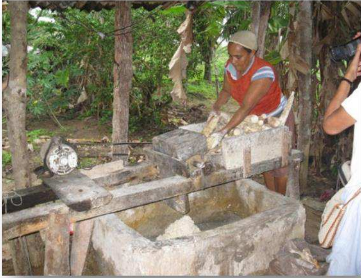
Photo 33 : Les maniocs en train d'être râpés dans une râpe motorisée (M.P, juillet 2010)
