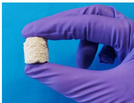
Figure 48 : PolyHIPE de type polyuréthane après retrait de la phase dispersée et séchage PU 80 -MIO
