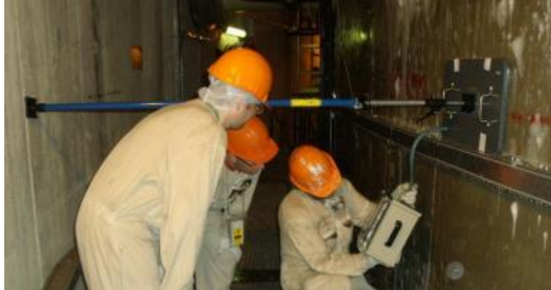
Figure 13. Boîte collectrice de fuite après aspersion de la surface d'eau savonneuse [Asali, 2016]
