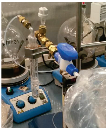
Figure IV-42 : Prise de vue du bulleur et de la valve permettant de simuler un échantillon d'air expiré
