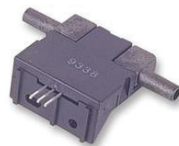
Figure III-17 : le capteur de flux gazeux AWM3300V
