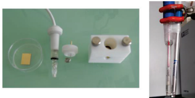
Figure III-1: Photo de la cellule électrochimique, de la macro électrode en or, des électrodes Référence/Contre à gauche Ag/AgCl - à droite calomel saturé
