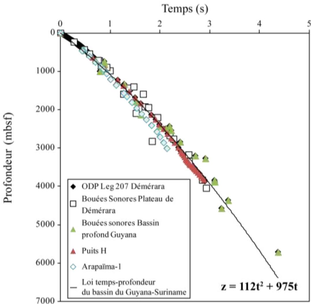
**Figure 4.4.** Compilation des données de vitesse à partir des mesures faites par des bouées sonores sur le Plateau de Démérara, dans le bassin profond du Guyana-Suriname (Diebold, 1996) et des check-shots issus des sites ODP du leg 207 (Plateau de Démérara, Shipboard Scientific Party, 2004) et du puits Arapaïma-1 sur le plateau continental.
