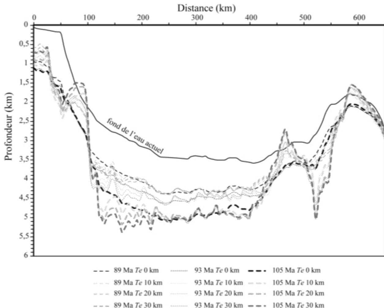
**Figure 4.10.** Section 2D backstripped décompactée d'après la Figure 4.7. illustrant l'évolution de la pléobathymétrie du plancher océanique pendant le Crétacé. Les lignes en pointillés correspondent à un pas de temps défini (105 Ma, 93 Ma, 89 Ma) et le dégradé de gris correspond à la valeur du paramètre  $T_e$  utilisée (0 km, 10 km, 20 km, 30 km). Le fond de l'eau actuel est représenté par la ligne noire continue.
