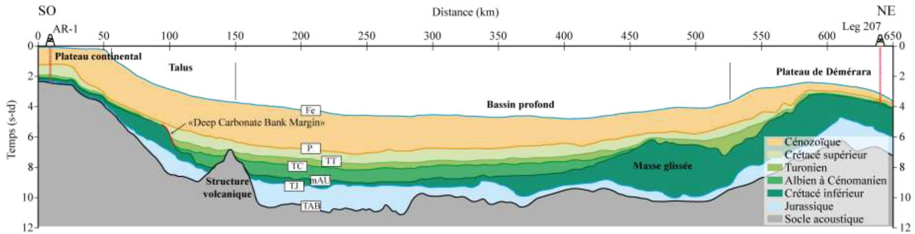
**Figure 4.3.** Section régionale illustrant la morphologie de la marge du bassin du Guyana-Suriname entre le puits Arapaïma-1 et les sites ODP du leg 207 situés sur le Plateau de Démérara. Fe : fond de l'eau. P : base du Cénozoïque. TT : Toit du Turonien. TC : Toit du Cénomanien. mAU : Discontinuité intra-Albien. TJ : Toit du Jurassique. TAB : toit du socle acoustique observé sur la section sismique réflexion 2D. AR-1 : puits Arapaïma-1.
