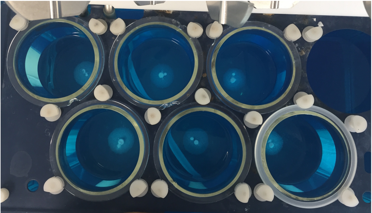
Figure 28 : Test de dissolution, après 60 minutes d'essai, de carbamazépine à 200 mg libération immédiate fabriquée en Chine, échantillonnée à Antananarivo, en zone urbaine, auprès d'un vendeur illégal
