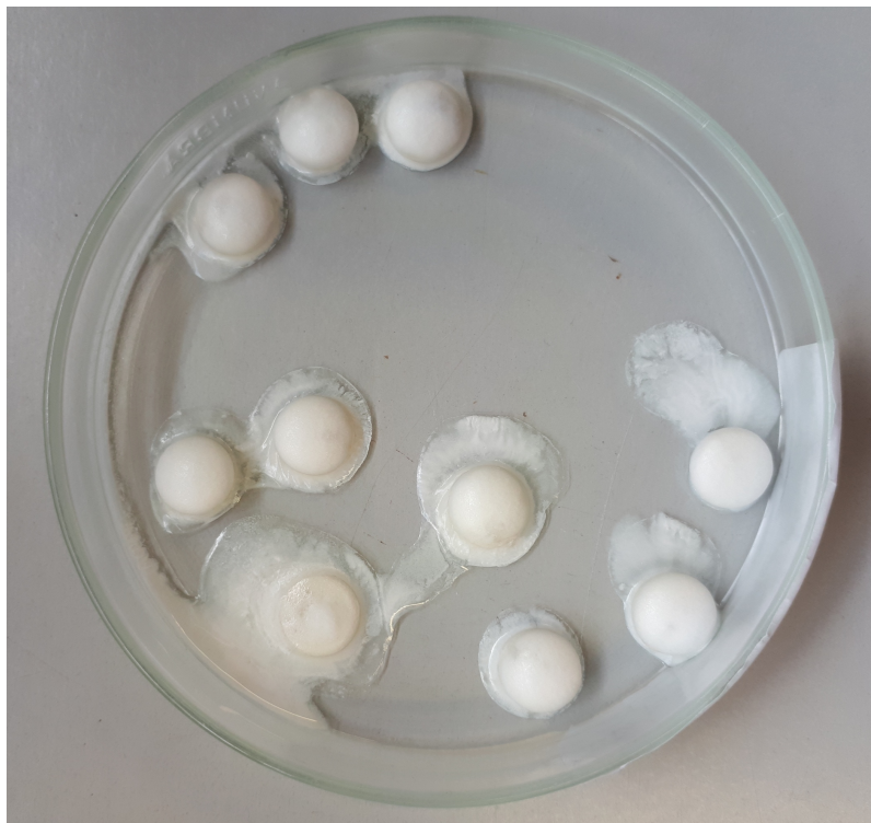
Figure 34 : Comprimés de valproate de sodium gastro-résistants dosés à 200 mg (fabriqués en Espagne) après exposition à 45°C et 75% d'humidité relative sans emballage
