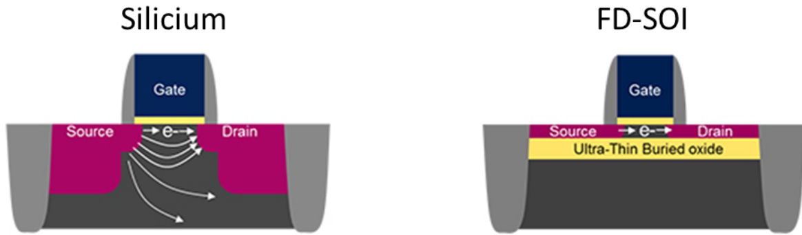
Figure 12 : Schéma représentatif d'un transistor sur plaque FD-SOI vs silicium classique (source : STMicroelectronics).
